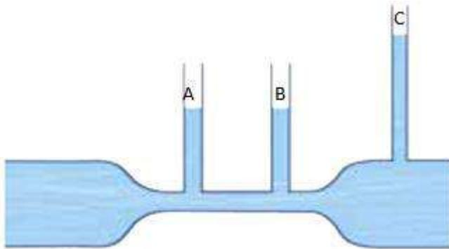
mediante un instrumento conocido como tubo de Venturi. El funcionamiento de este tubo se basa en el principio de Bernoulli y mide las velocidades a partir de las diferencias de presión entre el sector más ancho y más angosto del tubo, como el mostrado en la figura.
