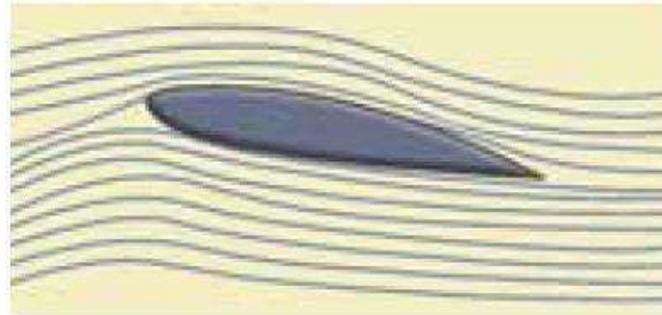
especialmente para que la velocidad del aire sea mayor en la parte superior que en la parte inferior. La razón por la cual el avión puede sostenerse en el aire es:
