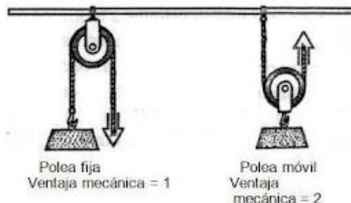
Una **polea**, otra máquina altamente útil, es una forma de palanca. Una polea hace el trabajo más fácil cambiando la dirección de la fuerza. Es una rueda acanalada sobre la que se desliza una cuerda. Para levantar un objeto con
